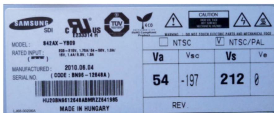
Figure 10-6. Étiquette informative des tensions requises pour une dalle plasma
