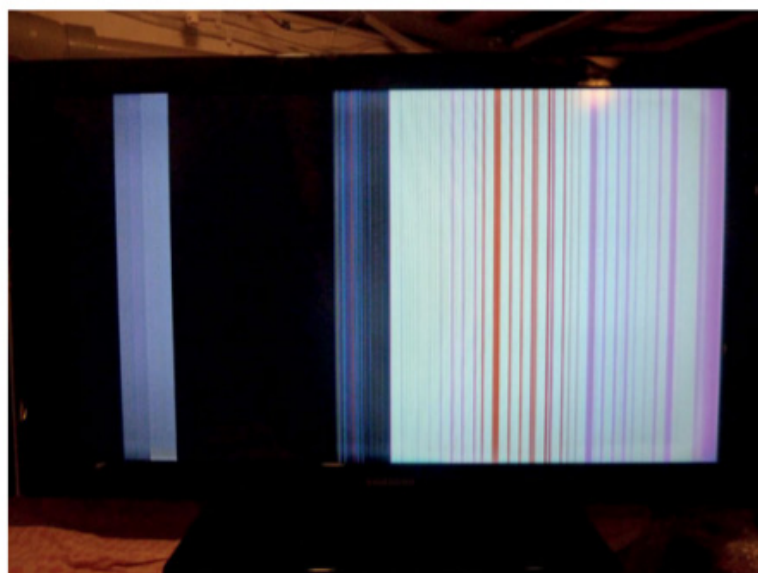
Figure 9-12. Exemple d'un défaut de connexion carte T-Con à dalle LCD
