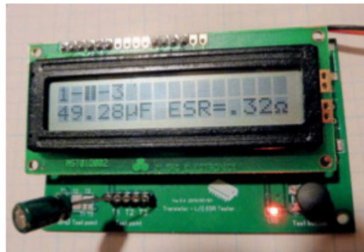
Figure 3-36. Vérification d'un condensateur électrolytique à l'aide d'un testeur universel
