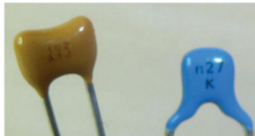
Figure 3-27. Exemples de marquage codifié de condensateurs
