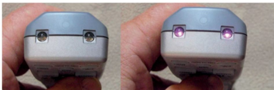
Figure 5-1. Vérification rapide d'une télécommande infrarouge à l'aide d'un appareil photo numérique
