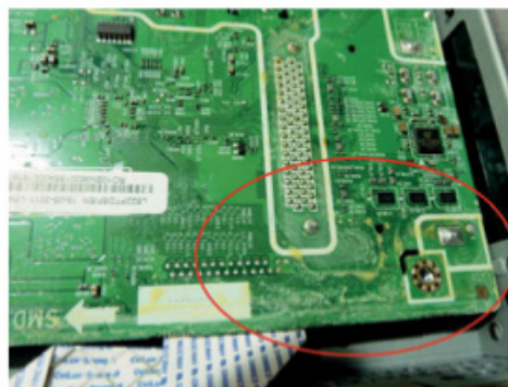
Figure 3. Traces de liquide ayant coulé sur le circuit d'un téléviseur
