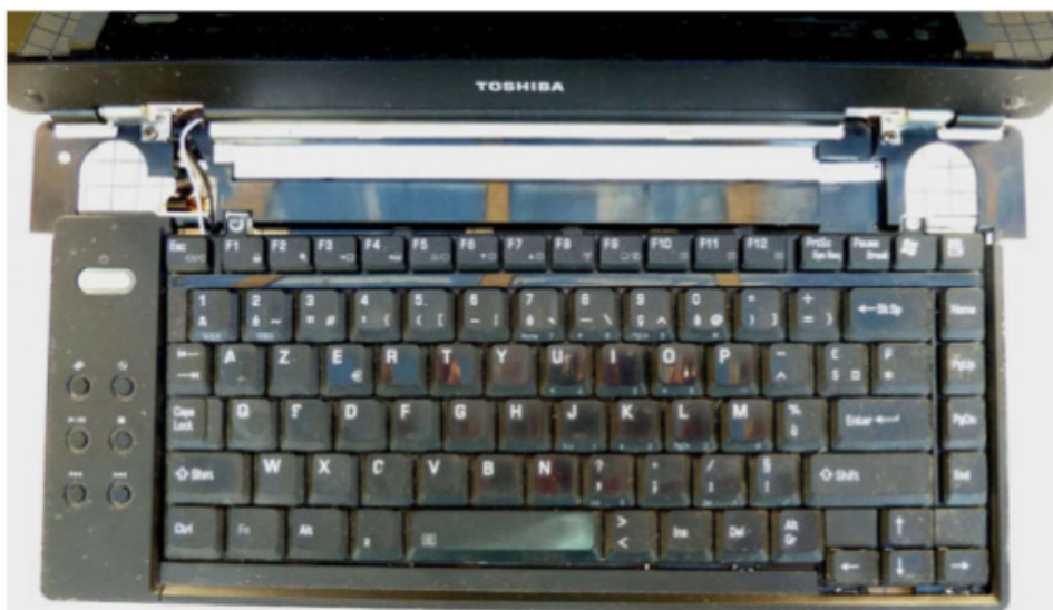
Figure 7-23. Clavier dans son emplacement du capot supérieur
