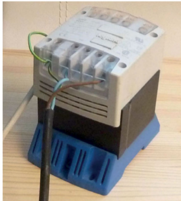
Figure 2-3. Transformateur d'isolement 220 V/220 V - 100 W
