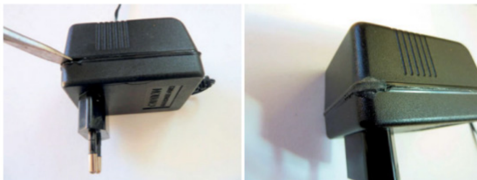
Figure 11-10. Ouverture et reconstitution d'un boîtier d'alimentation de portail vidéo
