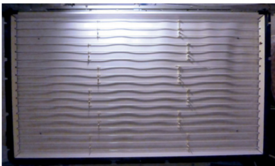
Figure 9-47. Intérieur d'un écran LCD dont la dalle d'affichage a été retirée.
