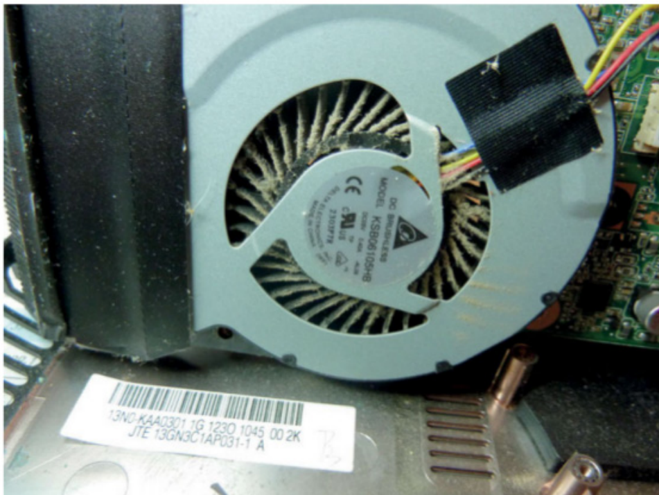
Figure 7-34. Encrassement du ventilateur
