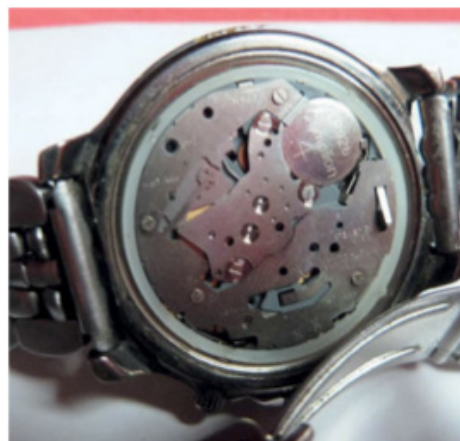
Figure 5-5. Accès à la pile d'une montre après ouverture du boîtier (fond vissé)
