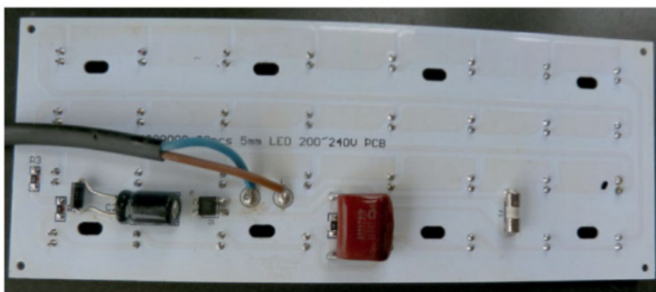
Fig 6-14. Vue de dos de la platine du circuit imprimé réparée, où une diode Zener a été ajoutée
