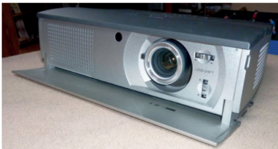
Figure 8-31. Vidéoprojecteur Home-Cinéma de type Tri-LCD à lampe conventionnelle
