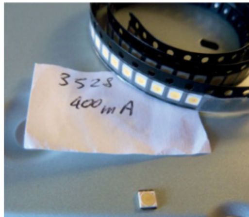
Figure 9-55. Diodes LED de remplacement livrées en film
