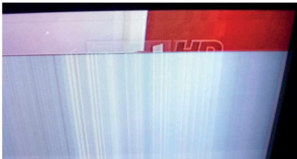
Figure 9-60. Défaut d'affichage qui n'a pas pu être réparé
