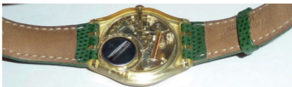
Figure 5-4. Montre avec capot protecteur de pile amovible
