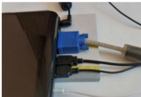
Figure 7-32. Connexions externes d'un ordinateur portable. Notez le soutien du connecteur VGA.
