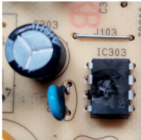
Figure 3-39. Circuit intégré explosé
