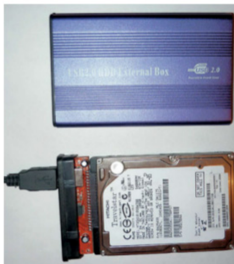
Figure 7-41. Disque dur d'ordinateur portable réutilisé dans un boîtier de disque externe USB
