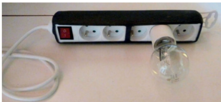
Figure 2-2. Prises mobiles dont une avec lampe à incandescence en série
