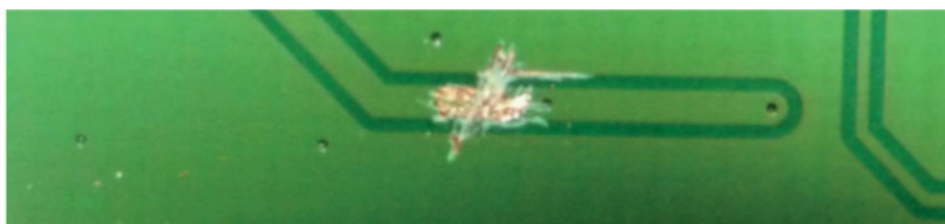
Figure 4-8. Coupure d'une piste < 1 mm sur une carte T-Con de téléviseur
