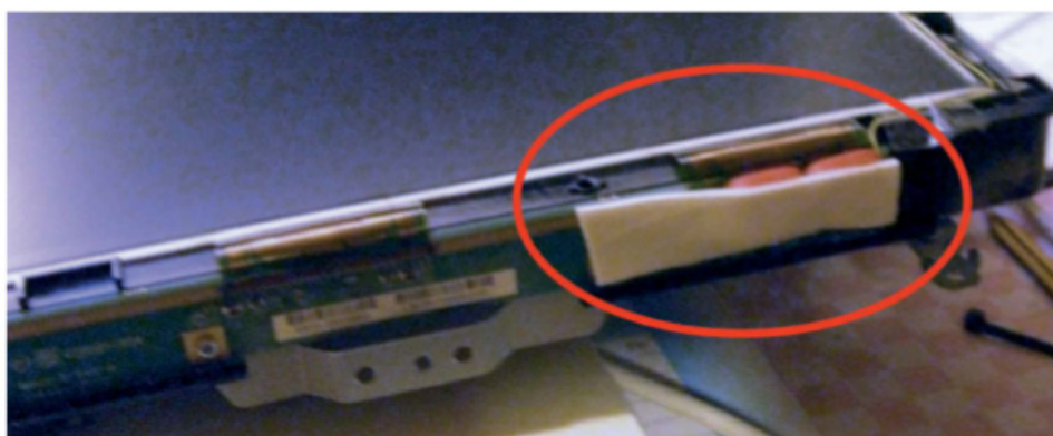
Figure 9-62. Réparation à l'aide de cales en caoutchouc et adhésif épais
