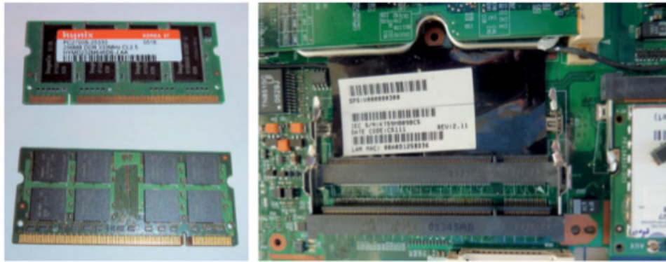
Figure 7-27. Barrettes mémoire d'ordinateur portable (à gauche) et leur support (à droite)
