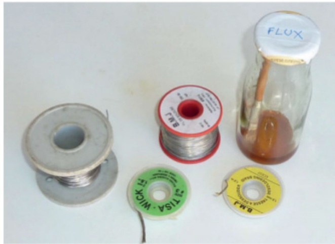
Figure 2-15. Tresse à dessouder, soudure et flux « fait maison »
