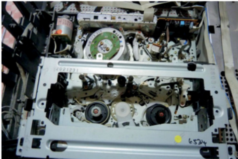
Figure 8-29. Mécanisme d'un magnétoscope VHS
