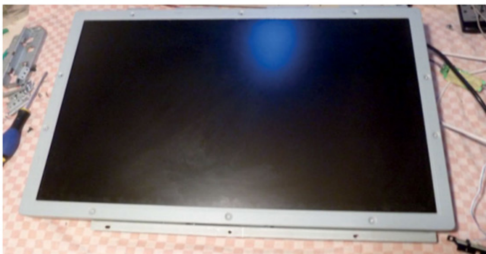
Figure 9-44. Il ne reste plus qu'à retirer le cadre métallique maintenant le panneau LCD.
