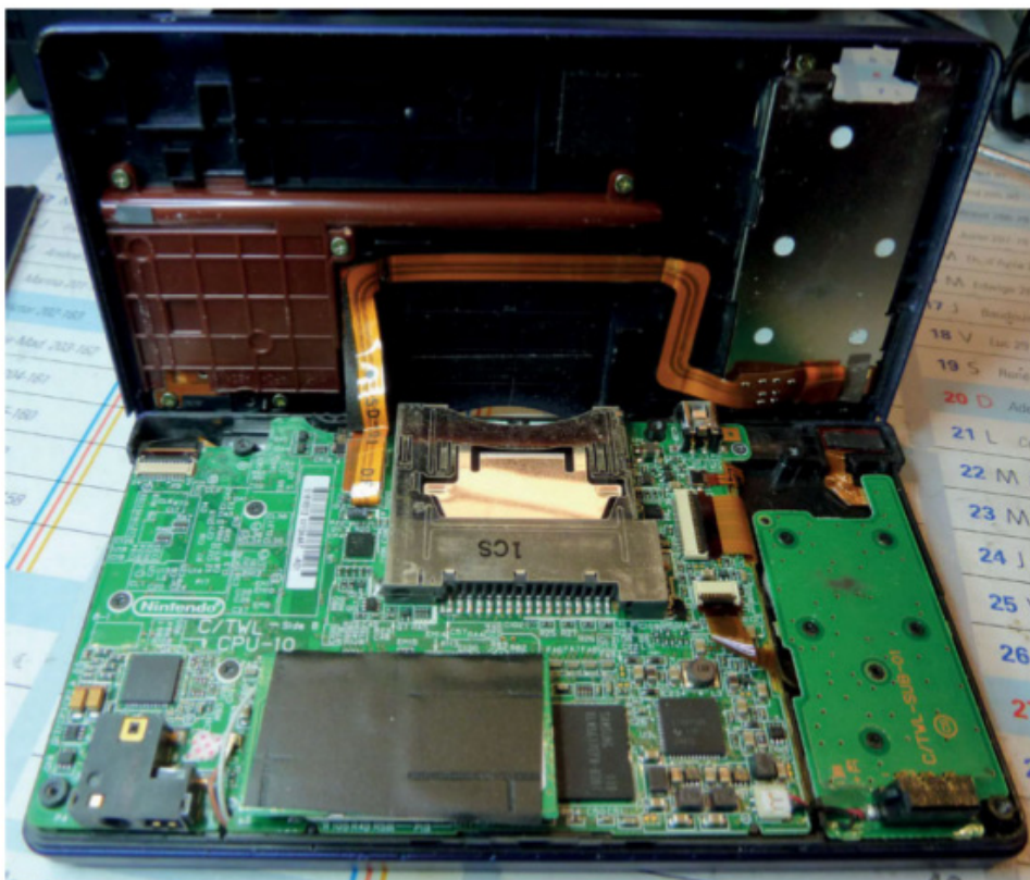
Figure 8-1. Ouverture d'une console double écran
