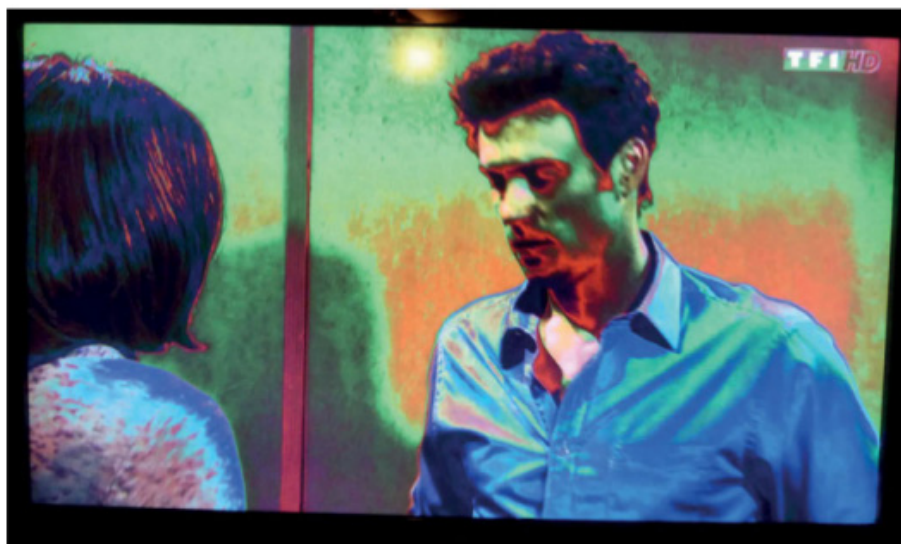
Figure 9-10. Exemple d'un défaut d'une carte T-Con
