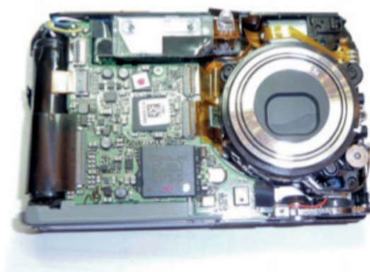
Figure 8-3. Démontage d'un appareil photo numérique à l'objectif bloqué
