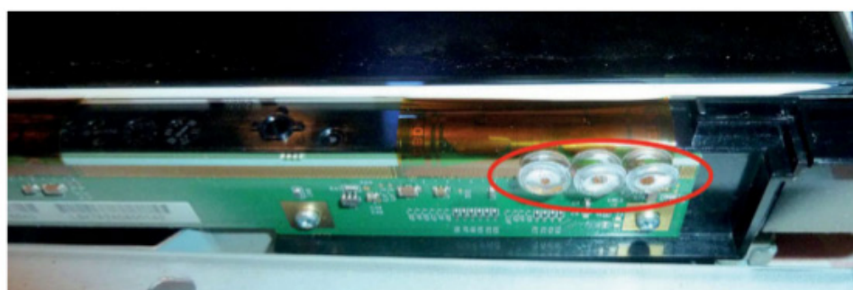
Figure 9-65. Rétablissement des contacts entre le circuit imprimé et un film côté vertical
