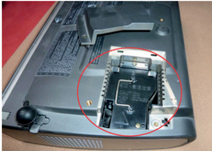
Figure 8-32. Trappe d'accès à la lampe d'un Tri-LCD
