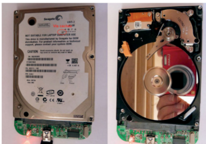
Figure 7-40. Ouverture d'un disque dur d'ordinateur portable
