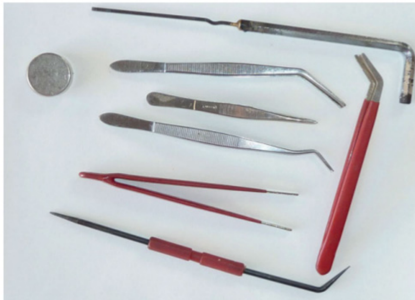
Figure 2-11. Quelques outils spéciaux dont un aimant et une clé Torx allongée
