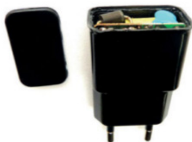
Figure 11-9. Boîtier de chargeur USB de smartphone ouvert, la diode de redressement a pu être changée.
