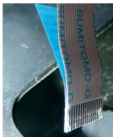
Figure 3-43. Câble plat avec languette de manipulation (sans verrouillage)
