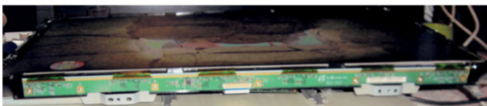
Figure 9-46. Vue du circuit imprimé de la dalle avec les films de connexion
