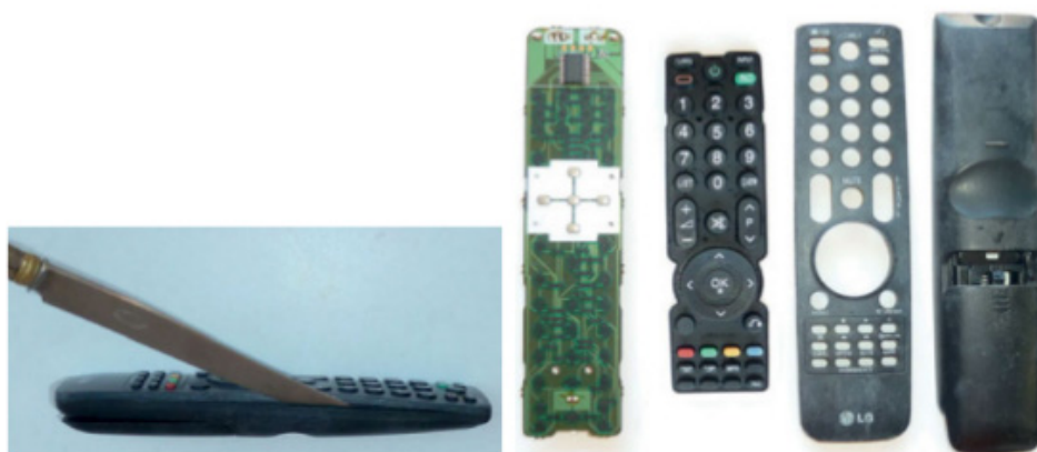
Figure 5-2. Télécommande démontée
