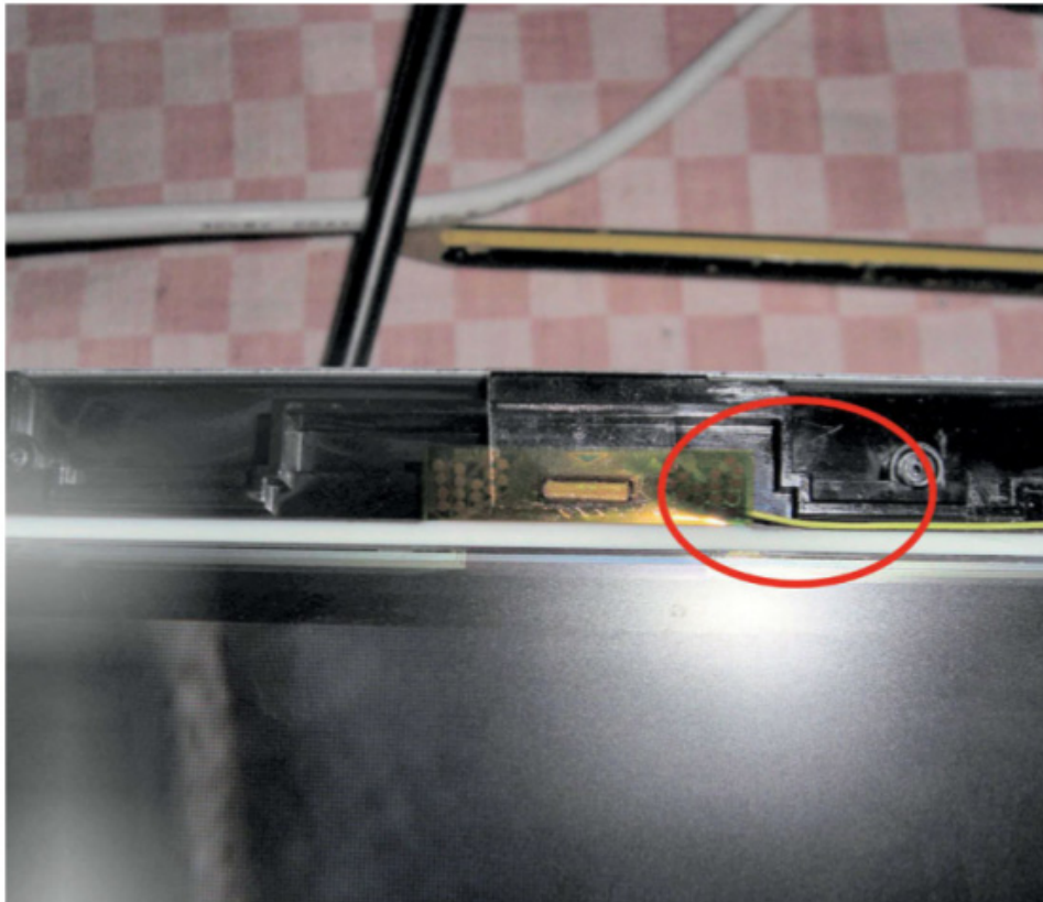
Figure 9-66. Film auquel la connexion filaire aboutit, on voit le circuit COF en transparence et les points de test à gauche du film.
