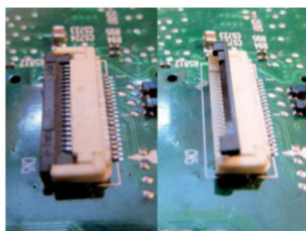
Figure 3-45. Connecteurs plats à verrouillage à clapet basculant
