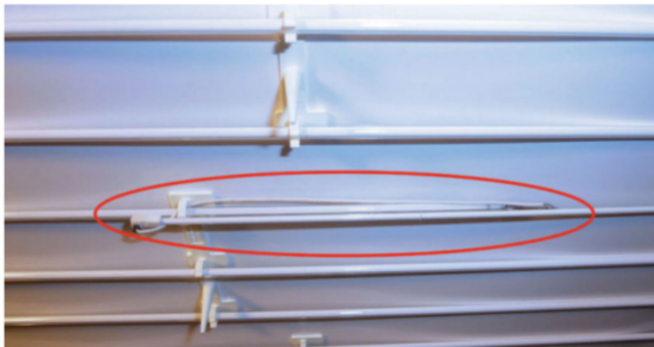
Figure 9-48. Réparation d'une dalle 46 pouces en associant deux tubes CCFL en série
