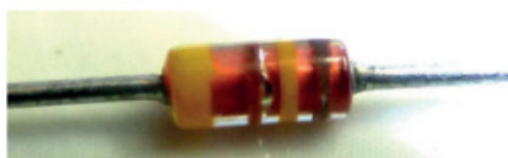
Figure 3-28. Exemples de marquage à anneaux de couleur (1N4148)
