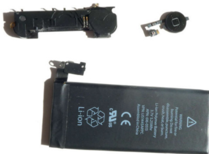
Figure 8-39. Batterie, bouton « home » et haut-parleurs d'un smartphone
