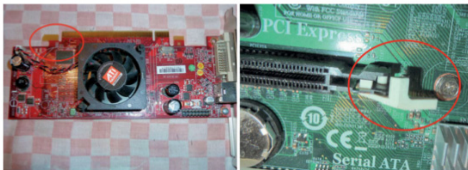
Figure 7-6. Carte vidéo démontée (notez l'ergot et le verrou du connecteur)
