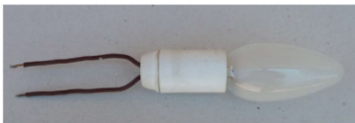
Figure 1-2. Lampe à incandescence utilisée pour la décharge des condensateurs
