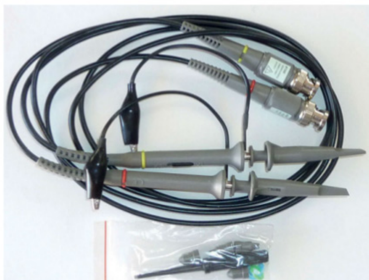
Figure 2-8. Sondes pour oscilloscope (diviseur par 1 et 10)
