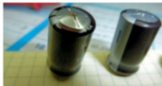
Figure 9-17. Condensateur gonflé à gauche, normal à droite
