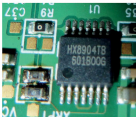
Figure 3-35. Marquage d'un circuit intégré HX8904TB (ligne 1)
