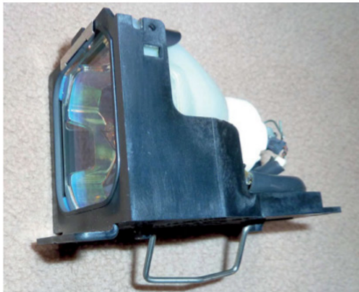
Figure 8-33. Bloc lampe d'un Tri-LCD
