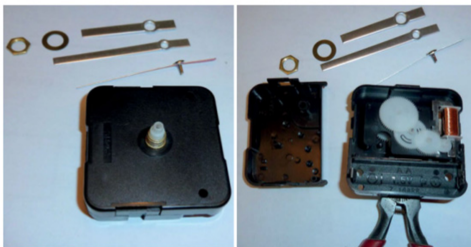
Figure 5-3. Mouvement standard d'horloge à quartz et ses aiguilles
