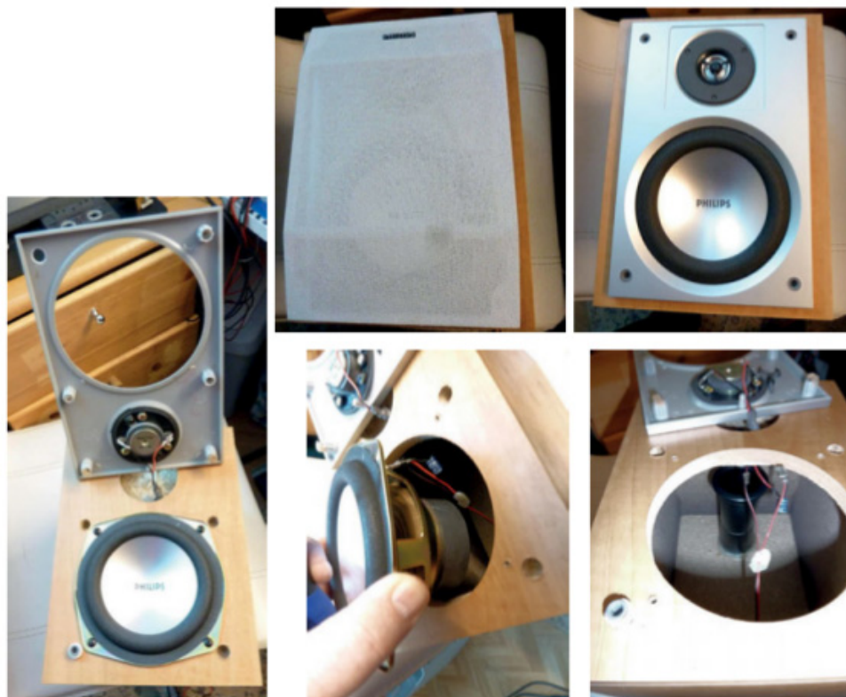
Figure-8-18. Démontage d'une enceinte deux voies
