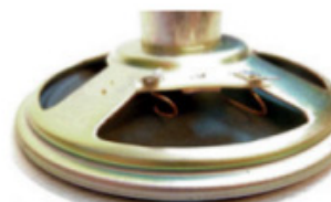
Figure 3-22. Vue des connexions d'une membrane
