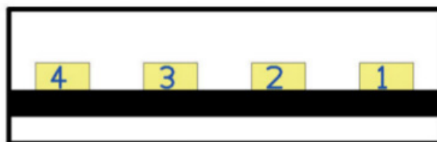
Figure 7-2. Prise USB A possédant 4 broches, câble côté ordinateur
