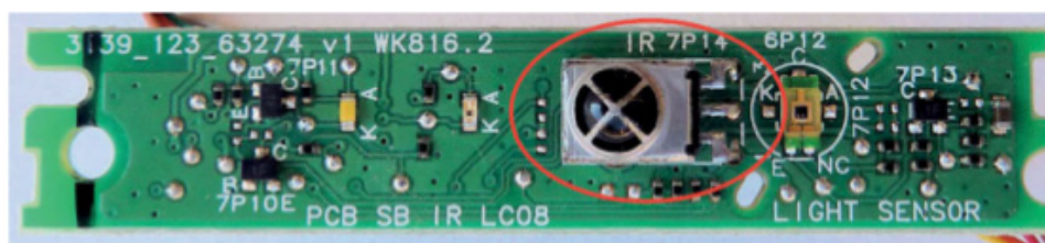
Figure 3-19. Récepteur infrarouge d'appareil télécommandé
