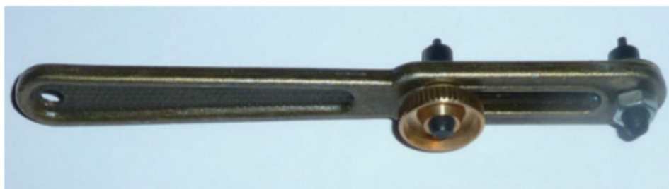
Figure 5-6. Outil facilitant l'ouverture du boîtier à fond vissé
