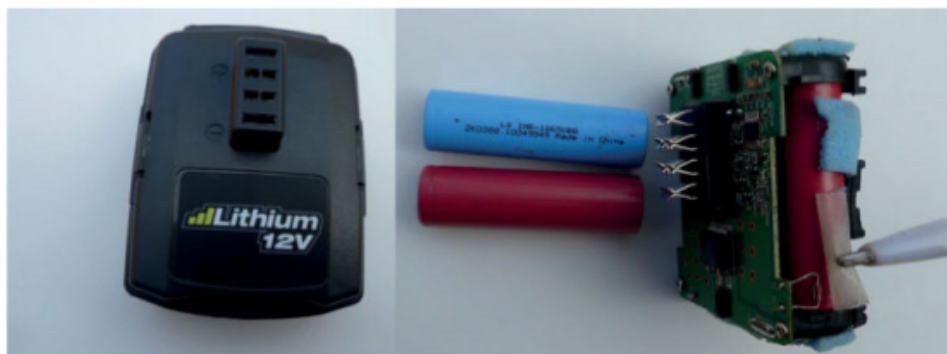
Figure 6-21. Bloc batterie d'une perceuse sans fil et les accus utilisés
