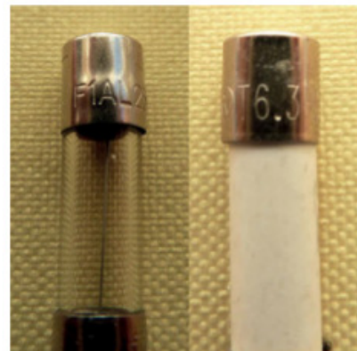
Figure 3-24. Marquage des cartouches : 1 A « fast » (rapide) et 6,3 A temporisé (lent)
