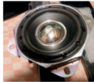
Figure 3-23. Réparation d'une membrane en mousse : pose des premiers points de collage
