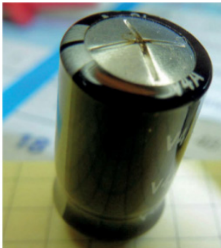
Figure 3-38. Condensateur électrolytique défectueux
