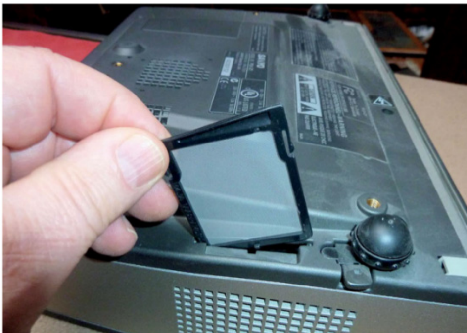
Figure 8-36. Démontage du filtre anti-poussière pour nettoyage
