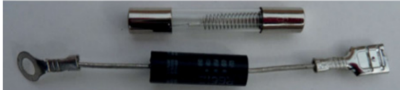
Figure 6-10. Diode et fusible haute-tension pour four à micro-ondes
