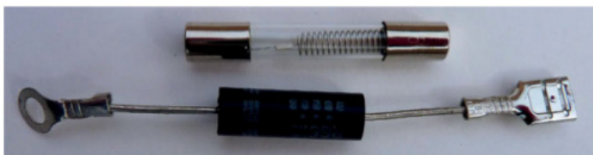
Figure 3-2. Fusible spécial du circuit magnétron d'un four à micro-ondes et la diode haute-tension
