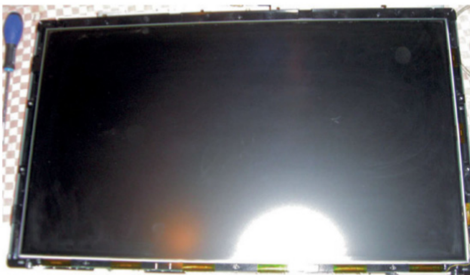
Figure 9-45. Cadre métallique enlevé, les films de connexion sont accessibles.
