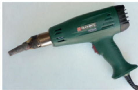
Figure 2-18. Décapeur thermique avec embout réducteur « maison »
