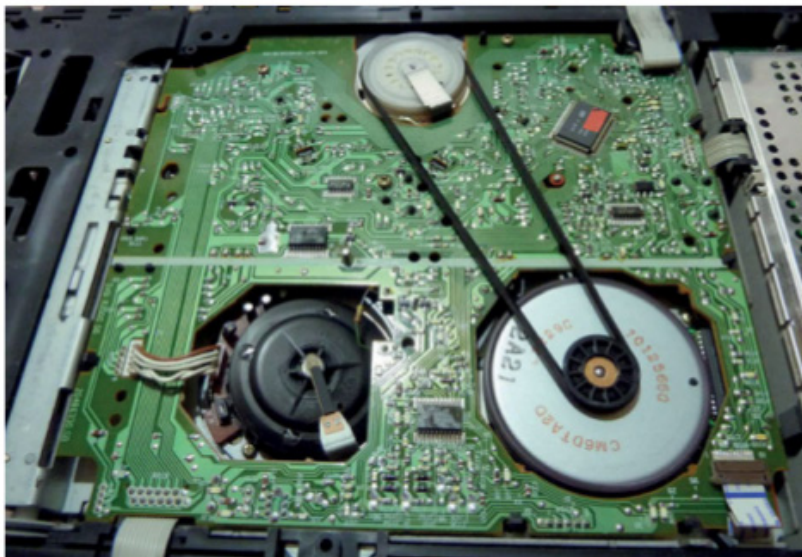
Figure 8-30. Vue de dessous du mécanisme logé dans le circuit imprimé
