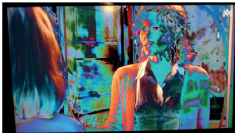
Figure 9-11. Autre exemple d'un défaut des circuits « gamma » d'une carte T-Con
