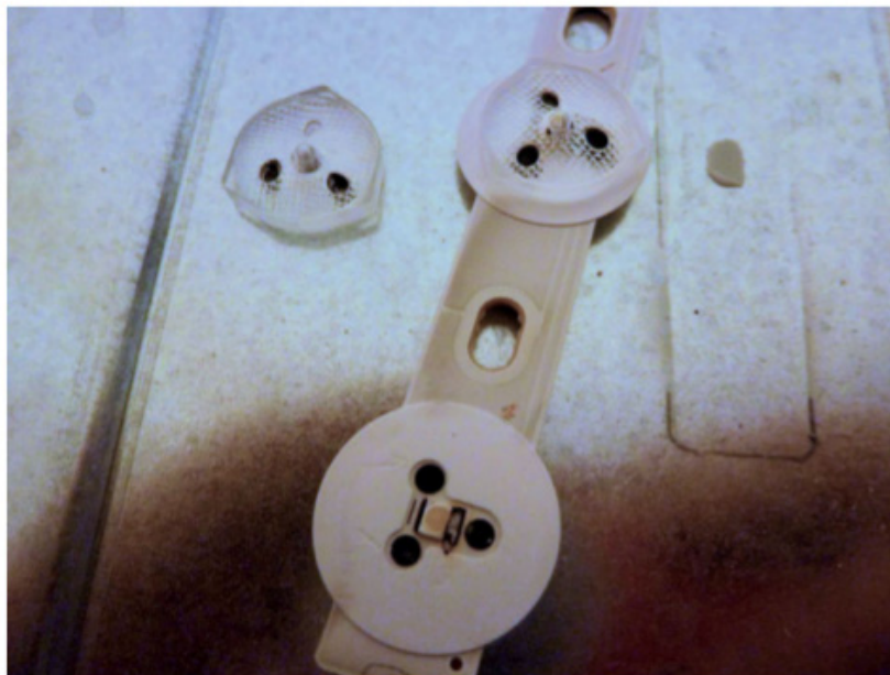
Figure 9-56. Décollage de la lentille
