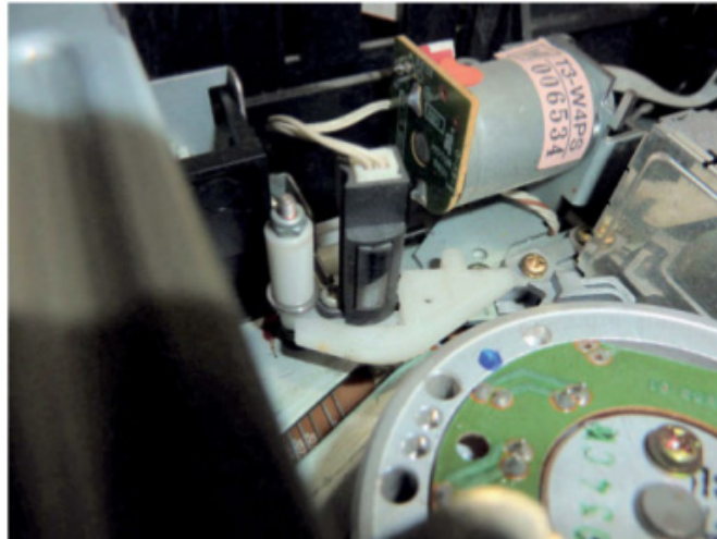
Figure 8-26. Tête d'effacement de magnétoscope VHS
