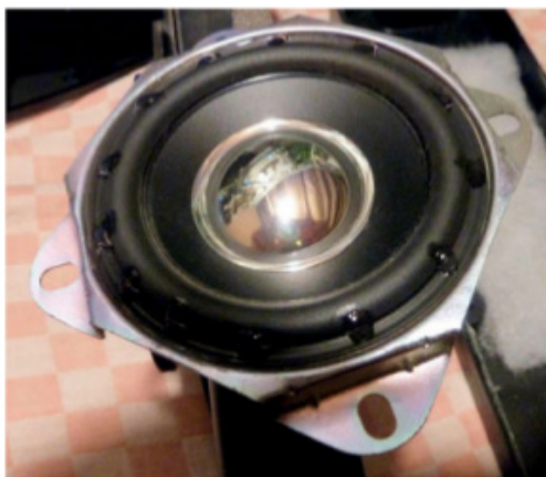
Figure 8-8. Haut-parleur à membrane détachée de la carcasse réparé à l'aide de colle
