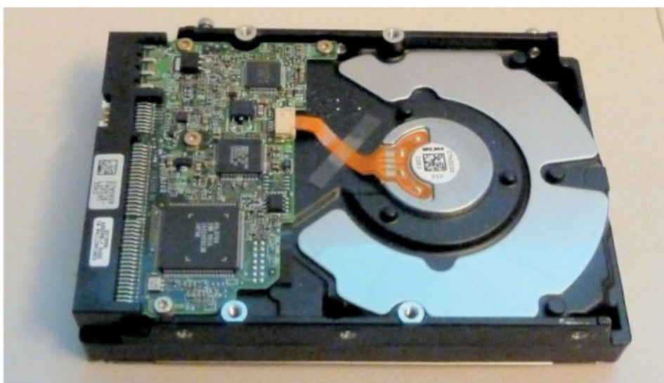
Figure 7-21. Disque dur IDE 3,5 pouces pour ordinateur de bureau
