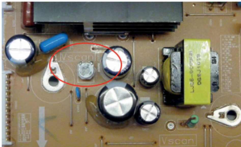
Figure 10-17. Réglage V_{scan} et son point de test (carte Y-scan)
