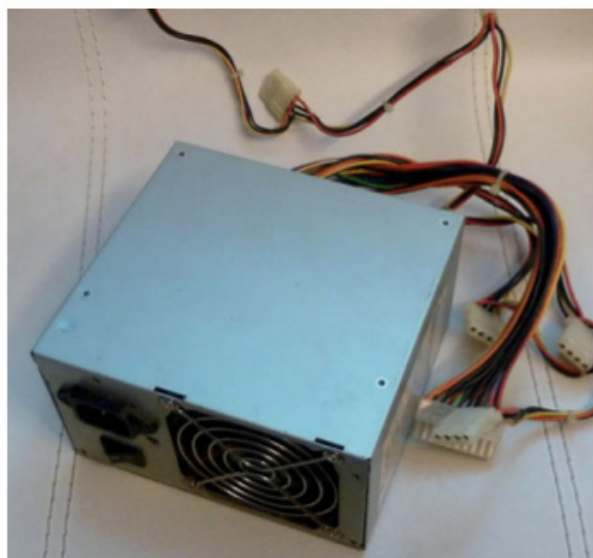
Figure 7-20. Bloc alimentation de type ATX standard pour ordinateur de bureau
