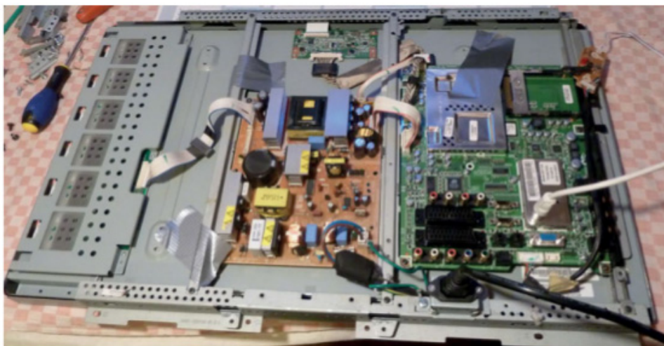
Figure 9-43. Dalle et circuits retirés du châssis de l'appareil, prêts pour un test
