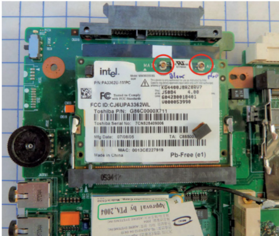
Figure 7-38. Carte Wi-Fi d'un ordinateur portable. Notez les connecteurs d'antenne.
