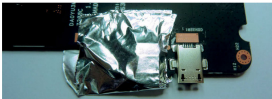
Figure 7-47. Protection environnement de connecteur micro USB soudé
