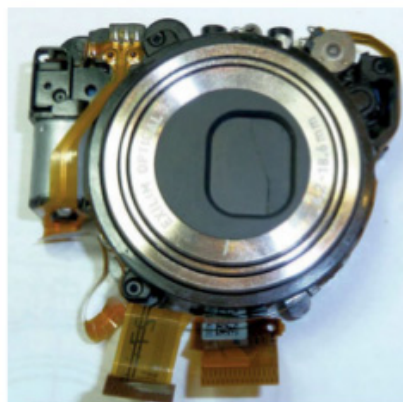
Figure 8-4. Bloc optique d'un appareil photo numérique
