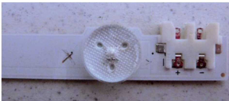
Figure 9-53. Indication de la polarité d'alimentation d'une barrette et repérage d'une LED défectueuse
