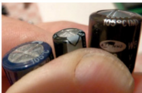
Figure 10-8. Condensateurs électrochimiques : les deux à droite sont anormalement gonflés
