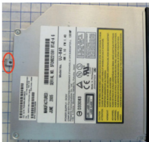
Figure 7-22. Lecteur/graveur de DVD pour ordinateur portable. Notez la patte de la vis de fixation.
