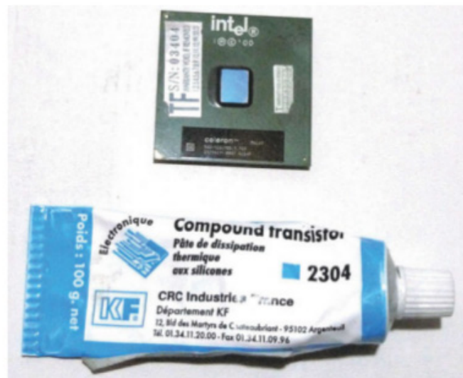
Figure 7-8. Microprocesseur et pâte thermique
